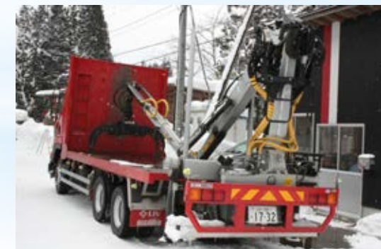
木材積載ユニット付木材運搬車
