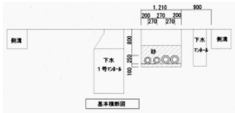
図 3-38 地域冷暖房設備の埋設配管断面
