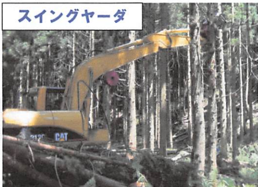
列状間伐で木寄せされた状態
