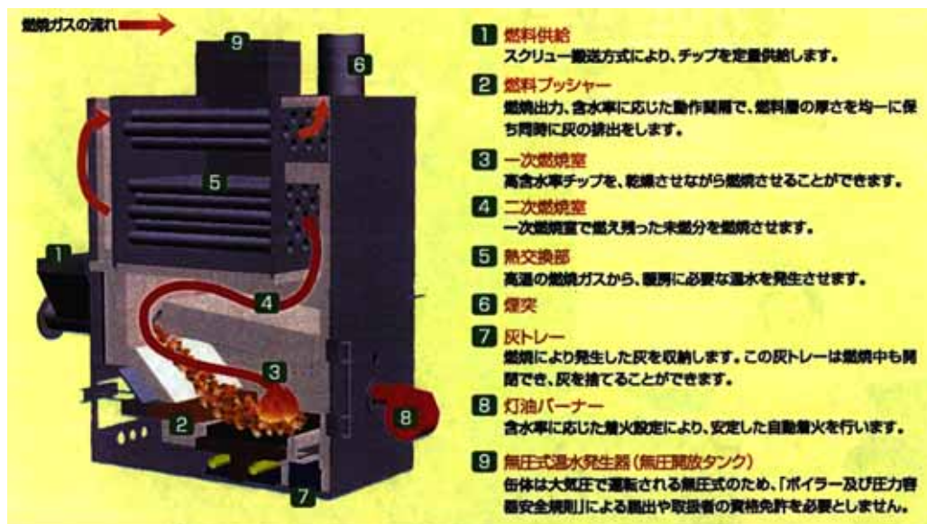
↑ いわて型チップボイラ：30～100Kw 本体説明図 （「木質バイオマスフォーラム 2005」）資料／作成：岩手県工業技術センターより）
